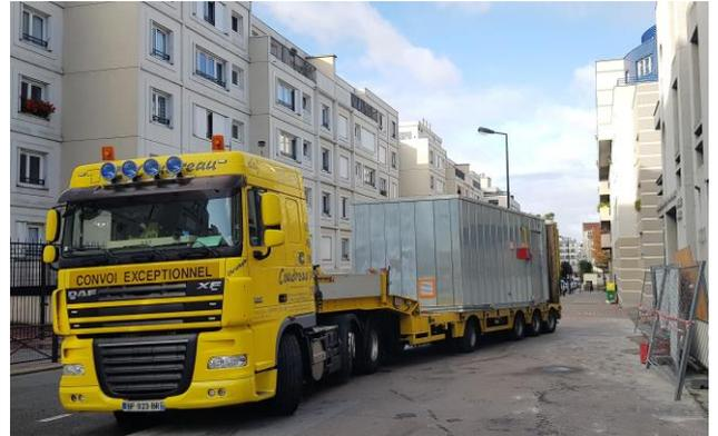
**Composition de la solution** : Une chaufferie préfabriquée de 240 kW Carrosserie en ALUMINIUM MO
